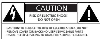
Ova 'munja' označava neizolovani materijal unutar uređaja koji može izazvati strujni udar. Nemojte skidati poklopac zbog sigurnosti svih u vašem domaćinstvu.
