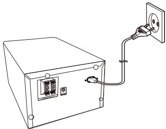
Priklučite kabel za napajanja u zidnu utičnicu.
