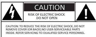
Ikonica „munja“ ukazuje da unutar uređaja postoji neizolovani materijal koji može dovesti do strujnog udara. Zarad bezbjednosti svih u domaćinstvu, molimo da ne otvarate kućište.
