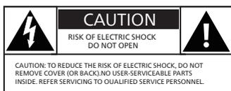
Este rayo indica que el material no aislado del interior del aparato puede provocar una descarga eléctrica. No retire la cubierta por seguridad de todos los miembros de su hogar.
