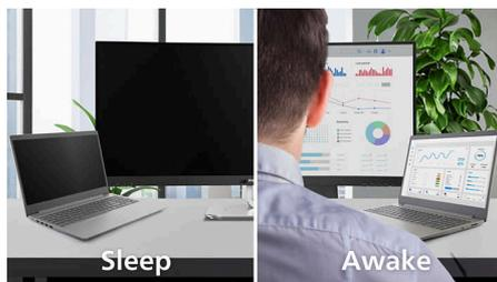
La funzione PowerSensor 2 di questo monitor è in grado di ridurre il consumo energetico rilevando quando gli utenti si avvicinano o si allontanano dallo schermo. Dopo aver impostato l'OSD su "Utente", è necessario regolare le impostazioni di Windows 11 affinché funzioni correttamente. Una volta effettuate le regolazioni, il monitor e il PC/laptop collegati si attivano quando qualcuno si avvicina ed entrano in modalità standby quando qualcuno si
