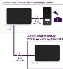
Puedes añadir hasta de 2 pantallas adicionales para tener un total de 3 monitores y conectar tantos smartphones como quieras. Esta pantalla adicional completará la instalación de tu videoportero WelcomeEye Connect 3 de Philips para cubrir una planta superior, otra zona de la casa o una construcción exterior.
