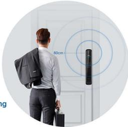
Ketika target mendekat dan berhenti di depan kunci pintu, modul sensor ultrasonik akan segera menghitung gelombang yang dipantulkan dari target. Jika mendeteksi gerakan manusia, pengenalan wajah akan mulai berfungsi. Data pengujian menunjukkan konsumsi daya modul sensor ultrasonik hanya 10% dari modul sensor inframerah konvensional, yang mana sangat hemat energi dan menjamin masa pakai baterai DDL702-8HWS yang tahan lama.
