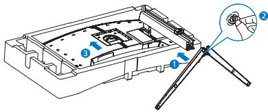
3. Nakon postavljanja baze, izdignite monitor objema rukama držeći monitor zajedno sa pjenastim stiroporom. Sada možete izvući pjenasti stiropor. Kada izvučete pjenasti stiropor, pazite da ne stisnete ploču kako ne bi pukla.
