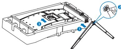
3. Po připevnění podstavce pevně uchopte monitor včetně fólie a postavte jej. Nyní můžete odstranit fólii. Při stahování fólie panel nesevírejte, aby se zabránilo jeho prasknutí.
