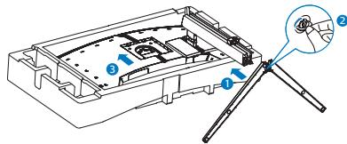
3. Nakon povezivanja postolja, uspravite monitor tako što ćete obema rukama čvrsto držati monitor zajedno sa stiroporom. Sada možete da izvučete stiropor. Kada budete izvlačili stiropor, ne pritiskajte panel da biste izbegli lomljenje panela.
