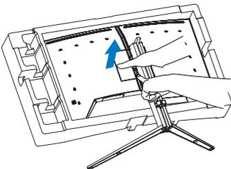
3. Bringen Sie die Verriegelung vorsichtig an der VESA-Halterung an, bis die VESA-Halterung an der Verriegelung einrastet.
