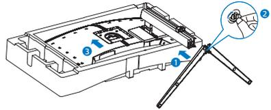
3. Richten Sie den Monitor nach Anbringung der Basis auf, indem Sie ihn mit beiden Händen sicher gemeinsam mit dem Styropor greifen. Nun können Sie das Styropor herausziehen. Drücken Sie den Bildschirm beim Herausziehen des Styropors nicht zusammen. Andernfalls könnte er beschädigt werden.
