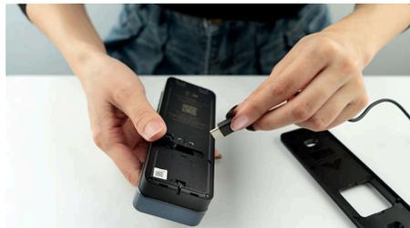
Vous pouvez raccorder le visiophone Philips au câblage de sonnette existant ou simplement le fixer au mur et le recharger via le port de recharge rapide lorsque la batterie est épuisée.
