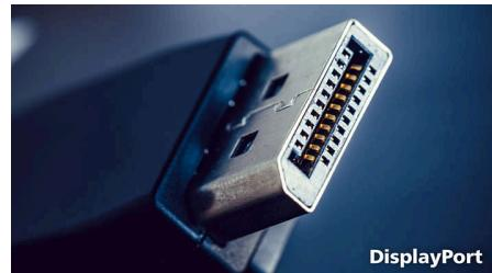
DisplayPort offre un collegamento digitale tra il PC e il monitor senza alcuna conversione. Con capacità superiori rispetto alla tecnologia DVI standard, supporta cavi di lunghezza fino a 15 metri e velocità di trasferimento dati di 10,8
