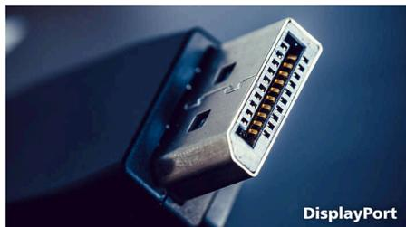
DisplayPort offre un collegamento digitale tra il PC e il monitor senza alcuna conversione. Con capacità superiori rispetto alla tecnologia DVI standard, supporta cavi di lunghezza fino a 15 metri e velocità di trasferimento dati di 10,8 Gbps/sec. Grazie a queste prestazioni e alla latenza zero, DisplayPort consente di ottenere la
