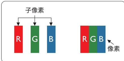
一个像素或像元由基色为红、绿、蓝的三个子像素构成。许多像素在一起形成一个图像。当一个像素的所有子像素都变亮时，三个不同颜色的子像素一起作为一个白色像素显示。当所有子像素都变暗时，三个不同颜色的子像素一起作为一个黑色像素显示。子像素的其他亮、暗组合将显示为一个其他颜色的像素。
