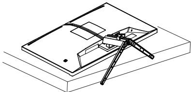
2. Нажав кнопку фиксатора, наклоните основание и извлеките его.
