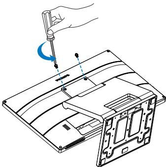
2. 如图所示，将支架移动到位。然后用螺丝刀拆下螺丝，再将支架从显示器上拆下。
