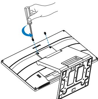
2. Deplasați suportul în poziția indicată în imagine. Apoi folosiți o șurubelnită pentru a scoate șuruburile, după care detachați suportul de monitor.
