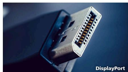
Интерфейс DisplayPort осуществляет прямую передачу цифровых сигналов с компьютера на монитор без преобразования. DisplayPort превосходит стандарт DVI и полностью поддерживает передачу данных с помощью 15-метрового кабеля со скоростью 10,8 Гбит/с. Высокая производительность и нулевая задержка обеспечивают наиболее быструю частоту обновления изображения. Поэтому
