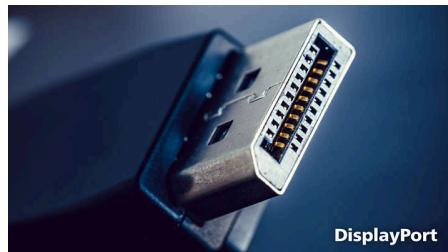
DisplayPort permet une connexion numérique entre l'ordinateur et le moniteur sans conversion. Plus puissante que la connexion DVI standard, cette technologie permet l'utilisation de câbles pouvant atteindre 15 mètres et des vitesses de transfert de données de 10,8 Gbit/s. Ces performances élevées et l'absence de latence vous garantissent les images et taux d'actualisation les plus rapides, ce qui fait de la
