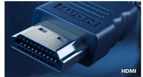
Ein HDMI ready-Gerät verfügt über sämtliche Hardware für den Empfang von HDMI-Signalen (High-Definition Multimedia Interface). Ein HDMI-Kabel ermöglicht hochwertige Audio- und Videosignale, die über ein einziges Kabel von einem PC oder anderen AV-Quellen (z. B. von Set-Top-Boxen, DVD-Playern, A/V-Receiver und Videokameras) übertragen werden.
