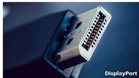
DisplayPort ist ein digitaler Anschluss vom PC zum Monitor ohne Konvertierung. Mit höheren Kapazitäten als DVI kann dieser Standard bis zu 15 Meter Kabel und eine Datenübertragung von 10,8 Gbit/s vollständig unterstützen. Mit dieser hohen Leistung ohne Latenz erhalten Sie die schnellsten Bild- und Aktualisierungsraten. Somit ist DisplayPort nicht nur die beste Wahl für die Verwendung im Büro oder zu Hause, sondern auch bestens für anspruchsvolle Spiele und
