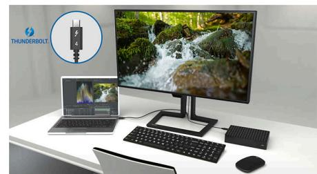
Ce moniteur avec station d'accueil Philips est équipé d'un connecteur Thunderbolt 4. Contrairement aux moniteurs USB-C conventionnels, la technologie Thunderbolt 4 permet un transfert de données ultra-rapide, prend en charge la vidéo haute résolution, offre un transport multi-flux pour une configuration en série et fournit jusqu'à 100 W d'alimentation aux périphériques externes.
