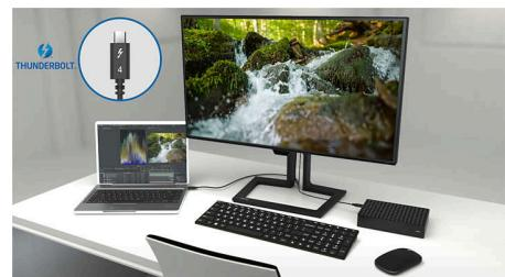
Dieser Philips Docking-Monitor verfügt über einen Thunderbolt 4-Anschluss. Im Vergleich zu herkömmlichen USB-C-Monitoren bietet die Thunderbolt 4-Technologie eine blitzschnelle Datenübertragungsgeschwindigkeit, unterstützt hochauflösende Videos, bietet Multi-Stream-Transport für Daisy-Chaining und eine bis zu 100 W starke Stromversorgung für externe Geräte.
