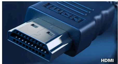
Uredaj s podrškom za HDMI ima sav potreban hardver za prihvatanje HDMI (High-Definition Multimedia Interface – multimedijalno sučelje visoke rezolucije) ulaznih signala. HDMI kabel omogućava reprodukciju vrlo kvalitetnih digitalnih video i audio signala koji se zajedno prenose jednim kabelom s računala ili bilo kojeg AV izvora (set-top box uređaja, DVD reproduktora, A/V prijemnika i kamkordera).
