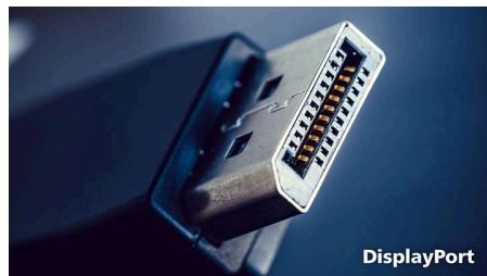
DisplayPort digitalna je veza između računala i monitora na kojoj ne dolazi do konverzija. Pruža veće mogućnosti od DVI standarda i u potpunosti podržava kabele duljine do 15 metara i brzinu prijenosa podataka od 10,8 Gb/s. Zahvaljujući iznimnim radnim značajkama i nultoj latenciji, moći ćete uživati u najbržim prikazima i najvećim brzinama osvježavanja — što
