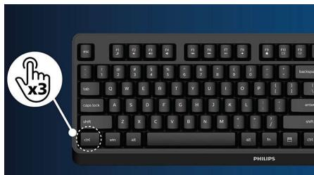
Za razliku od standardne ugradene tipke KVM na monitoru, Smart KVM omogućuje prebacivanje između izvora pritiskom tipke na tipkovnici. Kad su svi uređaji pravilno povezani, korisnici mogu lako prebacivati između izvora tako da tri puta pritisnu tipku „Ctrl“.
