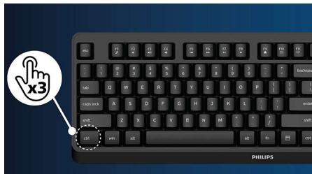
Za razliku od standardnog ugrađenog dugmeta KVM na monitoru, Smart KVM omogućava prebacivanje između izvora pritiskom na jedno dugme na tastaturi. Kada su svi uređaji pravilno povezani, korisnici mogu lako da se prebacuju između izvora tako što će tri puta pritisnuti taster „Ctrl“.
