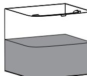
③ 倒掉檸檬酸溶液，清洗一遍原水箱後，即可正常使用。
