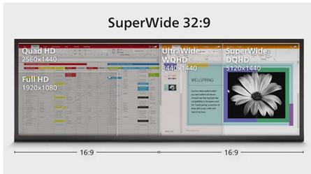
Le moniteur 32:9 SuperWide de 49" (124 cm) avec une résolution de 5 120 x 1 440 est conçu pour remplacer les configurations multi-écrans et offrir un affichage ultra-large. Il correspond à deux moniteurs Quad HD 16:9 de 27" (68 cm) installés côte à côte. Les moniteurs SuperWide présentent la même surface d'affichage que deux moniteurs, mais évitent une configuration compliquée.
