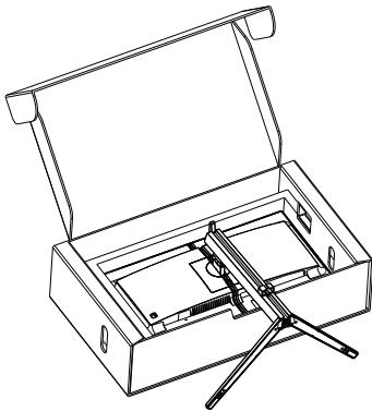
2. Нажав кнопку фиксатора, наклоните основание и извлеките его.
