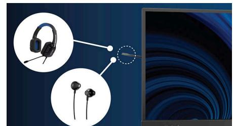
Die Kopfhöreraufbewahrung gab es mit dieser Funktion zuvor noch nicht. Ziehen Sie den Haken an der Seite des Monitors vorsichtig nach unten: Diese Funktion sorgt für einen aufgeräumten Schreibtisch und bietet eine praktische Lösung für das Kabelmanagement am Arbeitsplatz.
