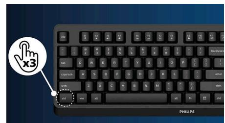
Im Gegensatz zu herkömmlichen integrierten KVM-Monitortasten ermöglicht das intelligente KVM das Umschalten zwischen Quellen mit einem Klick auf der Tastatur. Wenn alle Geräte ordnungsgemäß verbunden sind, können Benutzer einfach zwischen den Quellen wechseln, indem sie dreimal auf die Strg-Taste klicken.
