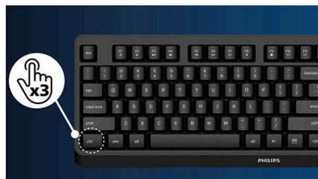
В отличие от традиционной кнопки KVM на мониторе SmartKVM позволяет переключаться между источниками одним нажатием кнопки на клавиатуре. Когда все устройства подключены должным образом, пользователи могут легко переключаться между источниками тройным нажатием кнопки Ctrl.
