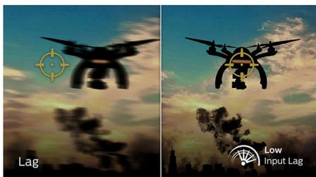
Kašnjenje ulaznog signala vrijeme je između izvršavanja radnje na povezanim uređajima i prikaza rezultata na zaslonu. Malo kašnjenje ulaznog signala znači da je manje vremena potrebno između unosa naredbe na uređaju i prikaza rezultata na monitoru, čime se uvelike poboljšava doživljaj igranja igri koje su osjetljive na brze pokrete (naročito važno za one koji igraju brze, natjecateljske igre).
