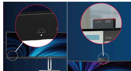
Cette fonctionnalité permet de travailler en solo et de collaborer de façon optimale dans un espace professionnel très fréquenté. Pour indiquer qu'il ou elle est occupé-e, il suffit à l'utilisateur ou à l'utilisatrice d'appuyer sur la touche de raccourci Busylight située dans le menu inférieur gauche du cadre du moniteur. Le voyant de la webcam devient alors rouge. En outre, la fonctionnalité Busylight peut également se synchroniser avec le statut dans Microsoft Teams.
