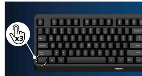
Contrairement à un commutateur KVM intégré classique pour moniteurs, le SmartKVM permet de basculer entre les sources d'une simple pression sur une touche de votre clavier. Lorsque tous les périphériques sont correctement connectés, vous pouvez passer facilement d'une source à une autre en appuyant trois fois sur la touche Ctrl.
