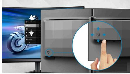
Die diskret angebrachte EasySelect-Menütaste ermöglicht die schnelle und einfache Änderung von Monitoreinstellungen im Bildschirmmenü.
