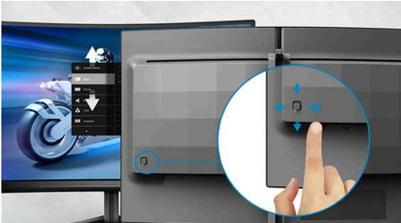
El botón EasySelect para alternar los menús, discretamente ubicado, permite realizar ajustes rápidos y sencillos en la configuración del monitor en el menú de visualización en pantalla.
