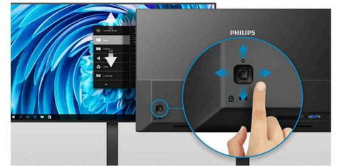
Die diskret angebrachte EasySelect-Menütaste ermöglicht die schnelle und einfache Änderung von Monitoreinstellungen im Bildschirmmenü.
