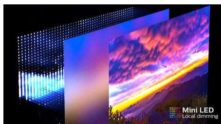
Mini LED pozadinsko osvjetljenje unapređuje kontrolu osvjetljenjem i omjerom kontrasta. Mala veličina mini LED-ica za pozadinsko osvjetljenje omogućava formiranje 1152 pojedinačno kontroliranih zona koje reproduciraju duble crne i svjetle bijele nijanse. Bogat HDR sadržaj sada možete gledati onako kako je zamišljen, uz neprikosnoven kontrast i preciznu reprodukciju.
