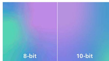
Dieses True 10-Bit-Farbdisplay von Philips ermöglicht die Anzeige farbkritischer Projekte mit außergewöhnlich hoher Farbtreue unter Einhaltung professioneller Standards. Im Vergleich zu einem herkömmlichen 8-Bit-Farbdisplay erzeugt dieser Philips Monitor einen natürlicheren Übergang zwischen Farbtönen für weichere Farbverläufe.
