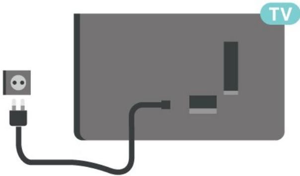
Meskipun pemakaian daya TV ini sangat rendah pada dalam Standby Mode, cabut kabel daya untuk menghemat energi jika TV tidak digunakan dalam jangka waktu panjang.
