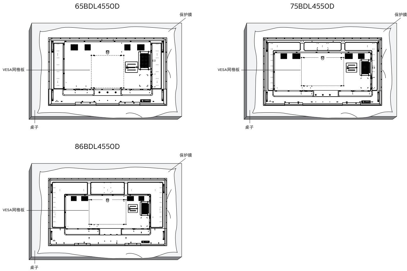
1. 将在平坦表面上包装显示器时在其周围包裹的保护膜展开。将显示器面朝下放在保护膜上，以便于操作而不会刮伤屏幕。
