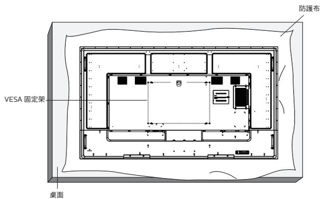
1. 在平坦表面上包裝智慧型顯示器時，請攤開原本包覆在智慧型顯示器上的防護布。讓智慧型顯示器正面朝下放置在防護布上，以協助您操作而不會刮傷螢幕。
