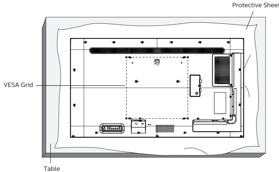
1. 在平坦表面上包裝智慧型顯示器時，請攤開原本包覆在智慧型顯示器上的防護布。讓智慧型顯示器正面朝下放置在防護布上，以協助您操作而不會刮傷螢幕。
