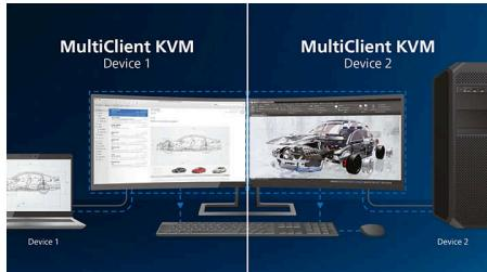
Con lo switch integrato KVM MultiClient, è possibile controllare due diversi PC con un'unica impostazione monitor-tastiera-mouse. Un comodo pulsante consente di cambiare rapidamente sorgente. Comodo per i dispositivi
