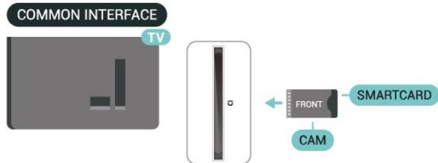
當您開啟電視時，CAM 需要幾分鐘才能啟動。若已插入 CAM 且已支付訂閱費用 (有多種不同的訂閱方式)，您可以觀賞 CAM 智慧卡支援的加密頻道。
