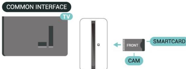
После включения телевизора до активации модуля CAM может пройти несколько минут. Если модуль CAM подключен, а подписка оплачена (возможны различные варианты подписки), вы можете смотреть зашифрованные каналы, которые поддерживаются смарт-картой CAM.
