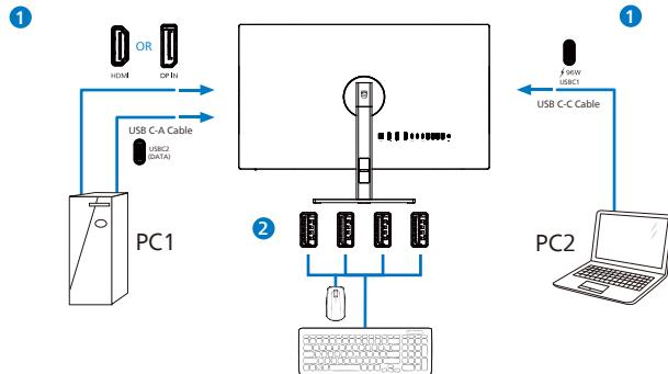
3. 进入OSD菜单。进入KVM层，通过选择“自动”“USB C”或“USB up”将外设的控制从一台设备切换到另一台设备。重复此步骤即可通过使用一组外设来切换控制系统。
