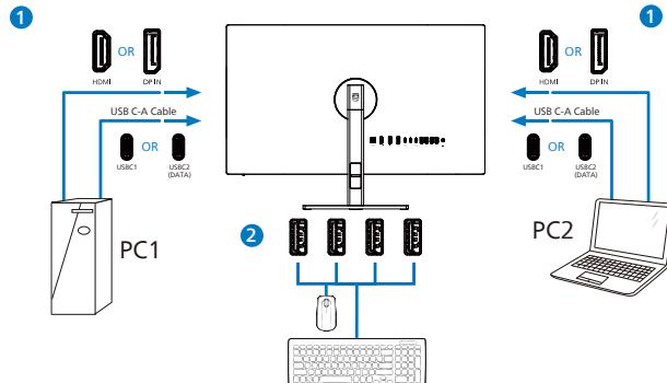
3. 进入OSD菜单。进入KVM层，通过选择“USB C”将外设的控制从一台设备切换到另一台设备。重复此步骤即可通过使用一组外设来切换控制系统。
