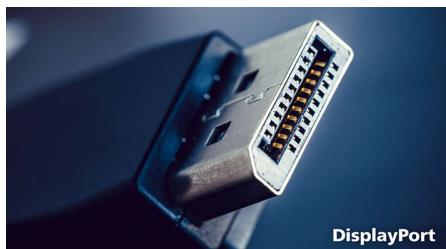
DisplayPort je digitalna povezava med računalnikom in monitorjem brez vsakršne pretvorbe. Ker je zmogljivejši od standarda DVI,
