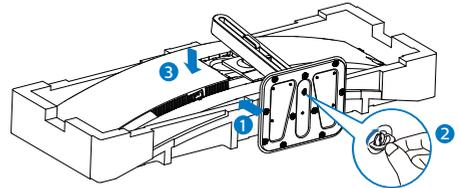
3. Dopo aver fissato la base, sollevare il monitor con entrambe le mani tenendo saldamente il monitor con il polistirolo. Ora è possibile estrarre il polistirolo. Quando si estrae il polistirolo, non schiacciare il pannello per evitare che si rompa.
