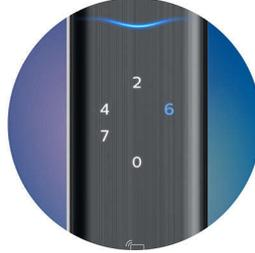
Philips EasyKey Alpha dilengkapi dengan fitur teknologi Kode PIN Palsu yang memungkinkan Anda memasukkan kombinasi angka acak agar berhasil diidentifikasi selama ada input kata sandi yang benar secara berurutan. Fitur ini secara efektif dapat mencegah orang lain mengintip kode yang dimasukkan dan melindungi kata sandi Anda yang sebenarnya.
