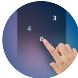
Dilengkapi teknologi kode PIN tersembunyi, kunci pintar Philips memungkinkan Anda memasukkan kombinasi angka acak agar berhasil diidentifikasi selama ada input kata sandi yang benar secara berurutan. Fitur ini secara efektif dapat mencegah orang lain mengintip kode yang dimasukkan dan melindungi kata sandi Anda yang sebenarnya.
